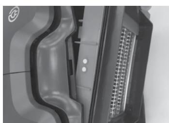
Filtreler yuvalarına yerleştirilirken önde polen filtre arkada elektrostatik filtre olmalı ve elektrostatik filtrenin siyah paneli arkaya bakacak şekilde cihaza takılmalıdır.
