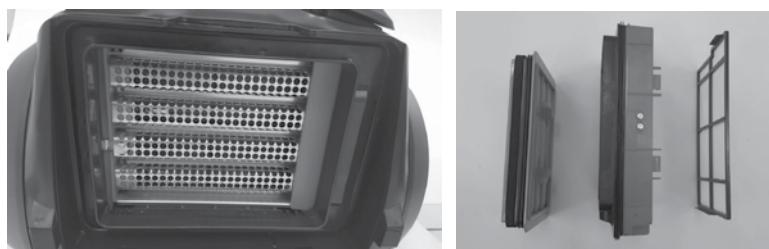
أدخل مجموعة فلتر الكربون النشط / H.E.P.A 13 في مجموعة المرشح الكهروستاتيكي بحيث يكون السطح البلاستيكي الأزرق متوجهاً للخارج.
