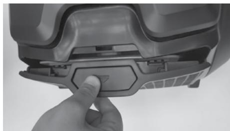
Ziehen Sie die ESF, Pollen und H.E.P.A 13 / Aktivkohlefilterkassette aus der Halterung, indem Sie am Griff auf der rechten Seite ziehen.
