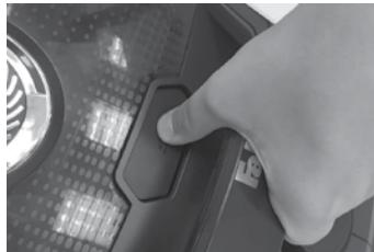
Öffnen Sie die Behälterabdeckung, indem Sie mit dem Daumen auf den Entriegelungshebel drücken.
